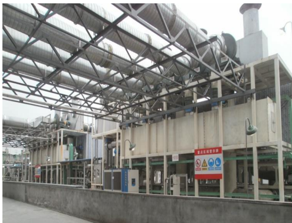
图 3-8 某彩印厂干复废气溶剂回收应用
